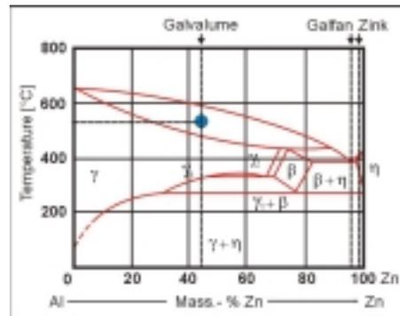
Fig. 41: Al-Zn phase diagram
