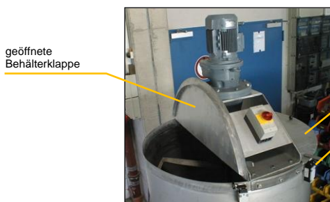
Elektro-Installation Typ A auf Rührwerksbehälter
