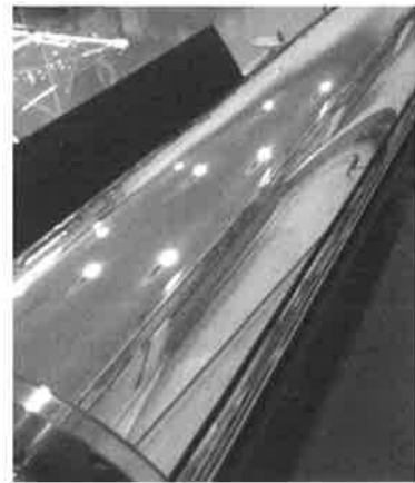
ステンレス円筒の外径を面粗さ Ra2 nm 以下にしたもの
