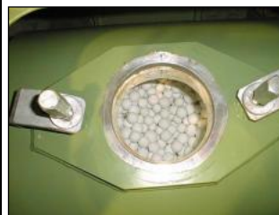
Hauptöffnung mit Mahlkugeln (hier A 2 O 3 )
