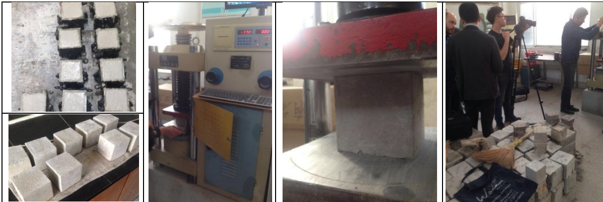
Bild 29a-c: Standard-Testwürfel vor und nach dem Ausschalen (linkes Bild), Testapparatur in Changzhou (Mitte), Videodokumentation der Versuche (rechtes Bild). Auf dem Stapel Testquader ist noch die Jutetasche einer Siegener Firma zu erkennen, per der Zoz zwei Betonklötze im Handgepäck nach China gebracht hatte.
