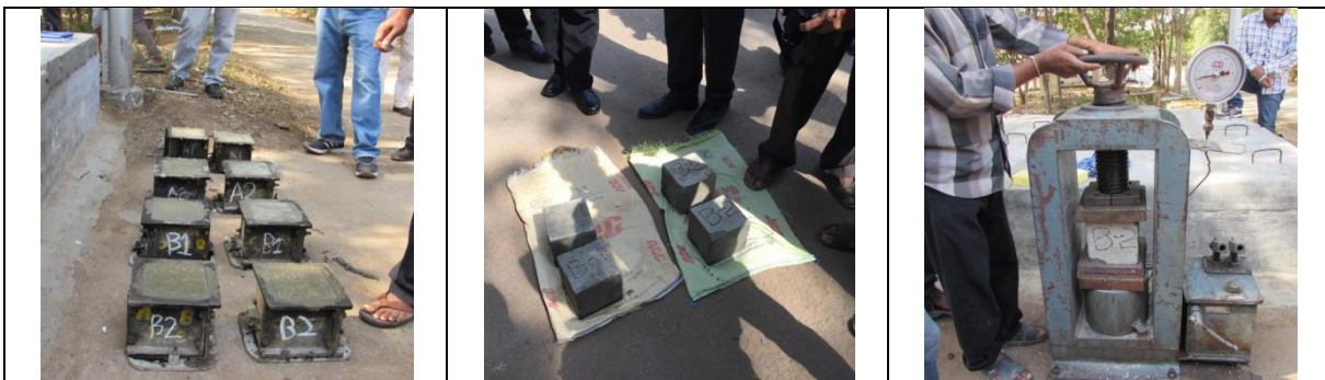
Bild 28a-c: Beton in Prüfformen gegossen, manuell gefertigte Testkörper und Druckfestigkeitsprüfvorrichtung, desolaten Festigkeiten aufgrund von Inhomogenitäten und der fehlenden Wirkung des Fließmittels nach Handvermischung des Betons
