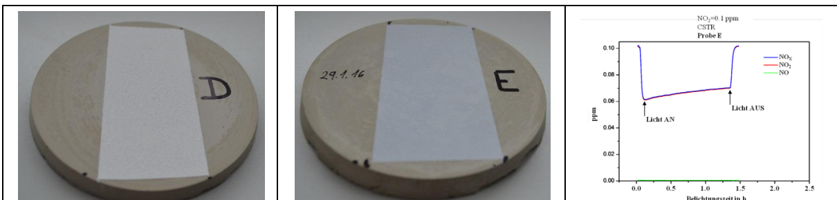
Bild 31a-b: Beschichtete FuturZement C.1 Leimproben, beschichtet mittels verschiedener Techniken, D: beschichtet mit weißer silikatischer Farbe, 2 Tage trocknen 3 Schichten durch Aufsprühen; E: Beschichtung mit 3 Schichten durch Spitzpistole
