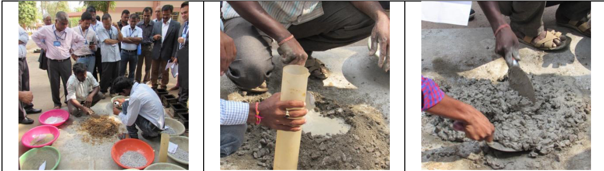
Bild 27a-c: komplett falsch: manuelles Anmischen kann und wird nicht zu repräsentativen Ergebnissen oder verbesserten Eigenschaften von FuturBeton führen
