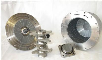
Fig. 17b: Grinding-unit W01-2Im-SiN
