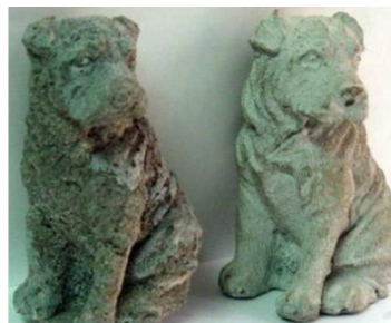
由传统普通硅酸盐水泥制成的雕塑(左)和由精制/HPPC 制成的雕塑(右)
