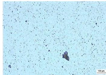
Lichtmikroskopische Aufnahme GCC-HPPC Zementpulver (hergestellt unter Code m60-40-500)
