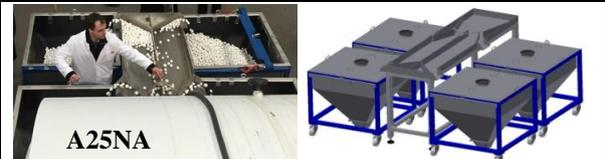
Mahlkugelverteilanlage mit Füllbehältern FB500a (an A25NA)
