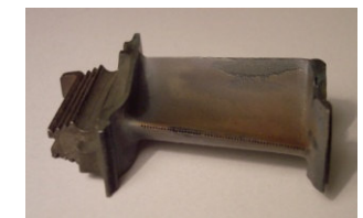
Turbinenschaukel RB199 Quelle: Wikipedia, Stahlkocher
