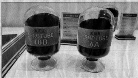
▲CNT는 LIB 양극과 음극 도전체로 적용이 활발해지고 있다. 제이오는 양극재에 들어가는 Thin Wall CNT 'JENOTUBE 10B' (좌)와 음극재에 들어가는 Thin Wall CNT 'JENOTUBE 6A'를 생산하고 있다.
