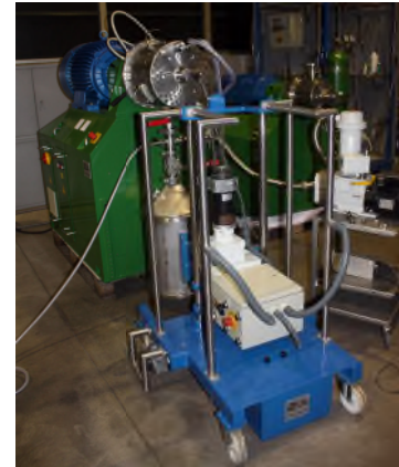
Passivierungsbehälter RBP50 mit Schleuse DN50KF, Belüftungsventil und Vakuum-Pumpe an einem Manipulator DV63-01 vor einem Simoloyer CM20 zur Herstellung von Al-Matrix-Werkstoff
