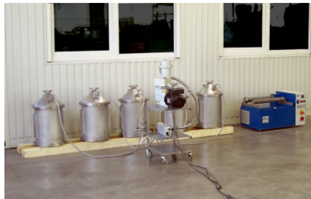
Handling hochreaktiver Werkstoffe: 4 Stk RBP50 am Vakuum-Pumpstand
