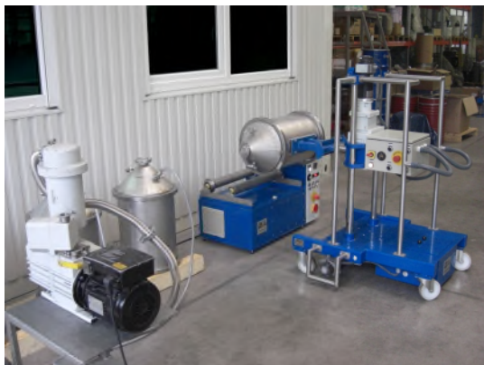
RBP50 wird für die kontrollierte Passivierung von Al-Basiswerkstoff mittels DV63-01 auf Rollenmühle RM20 platziert
