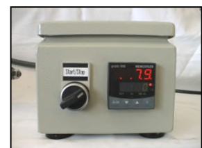
elektrische Kontrolleinheit für Vakuum-Heizrohr HR63-1
