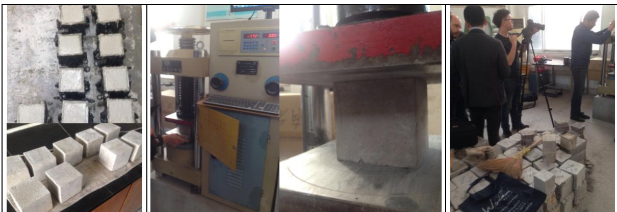
Standard-Testwürfel vor und nach dem Ausschalen (linkes Bild), Testapparatur in Changzhou (Mitte), Videodokumentation der Versuche (rechtes Bild). Auf dem Stapel Testquader ist noch die Jutetasche einer Optikerfirma in der Eiserfelder Strasse zu erkennen, per der Prof. Zoz zwei Betonklötze im Handgepäck nach China gebracht hatte.
